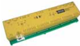
Parametrizable safety controller FPSC
